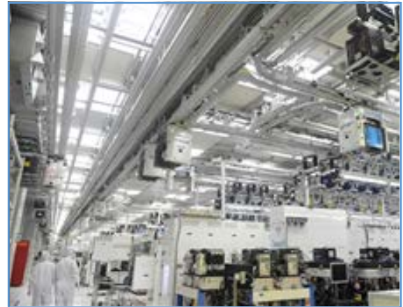
반도체 공장의 천장대차시스템(OHT, Overhead Hoist Transfer) 시스템 예시 사진(출처 : SK하이닉스 뉴스룸)
