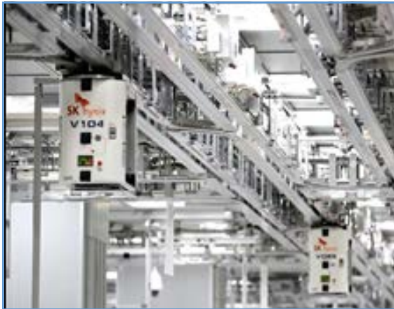
반도체 공장의 천장대차시스템(OHT, Overhead Hoist Transfer) 시스템 예시 사진(출처 : SK하이닉스 뉴스룸)
